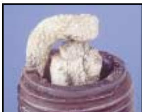
9. ASH DEPOSITS 9. DÉPÔTS DE CENDRE 9. DEPOSITOS DE CENIZA
