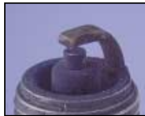
7. CARBON FOULED 7. ENCRASSEE AU CARBONE 7. DEPOSITOS DE CARBON
