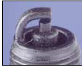
3. FUEL FOULED 3. ENCRASSEE DE COMBUSTIBLE 3. SUCIEDAD DE COMBUSTIBLE
