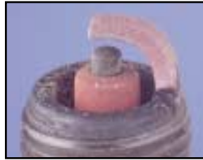
2. NORMAL WITH RED COATING 2. NORMALE AVEC UNE COUCHE ROUGE 2. NORMAL CON UNA CAPA ROJA
