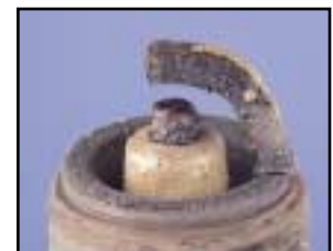
12. LEAD FOULED 12. ENCRASSEMENT AU PLOMB 12. SUCIEDAD DE PLOMO
