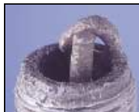
11. MECHANICAL DAMAGE 11. DOMMAGE MECANIQUE 11. DAÑO MECANICO
